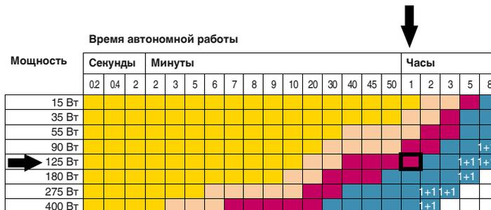
Энергоаккумуляторы UPS-BAT/VRLA: UPS-BAT/VRLA/24DC/1.3AH (зеленый), UPS-BAT/VRLA/24DC/3.4AH (желтый), UPS-BAT/VRLA/24DC/7.2AH (оранжевый), UPS-BAT/VRLA/24DC/12AH (розовый), UPS-BAT/VRLA/24DC/38AH (синий)
